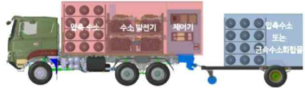
< 이동형 수소 연료발전기 및 수소공급장치 모식도 >
